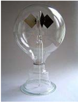
Figure 4.4 ▲ Radiomètre de Crookes: Même avec un vide parfait, il n'est pas assez sensible pour observer une rotation à l'oeil nu.
